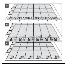
Вставьте ряд X в уложенный пол с помощью монтажного ломика. Не забудьте установить расширительные распорки.
