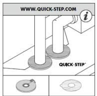
Для обеспечения идеальной отделки вокруг стояков используйте специальные розетки Quick-Step или заполните температурный шов эластичным герметиком.
