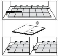
После укладки второго ряда, отмерьте и отрежьте плитку размером Y между стеной и законченным рядом. Не забудьте вставить расширительную распорку. Вставьте плитку Y, сдвинув на 10 см относительно линии соединения 1-го и 2-го рядов.
