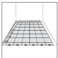
Теперь соедините ряд с уложенным полом с помощью монтажного ломика.
