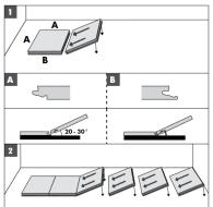
Установите первую плитку в левом углу комнаты (примерно в 15 см от стены) так, чтобы обе ее стороны с шипами были повернуты к стене.
