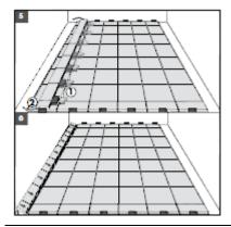
Исправьте мелкие погрешности с помощью бруска (см 1). Переместите ряд межу стеной и уложенным полом.
