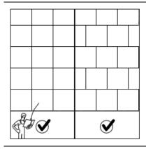
Плитки можно устанавливать в любом направлении. Укладку следует начинать с любого угла. Устанавливайте плитки слева направо, соединяя их с непрерывным швом или в шахматном порядке. Укладка плиток с непрерывным швом — немного более сложный метод, поэтому ниже мы подробно объясняем его.
