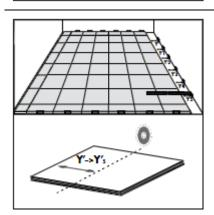
Для того чтобы завершить укладку пола нужно сформировать правый ряд. Для этого отмерьте и выпилите ряд плиток  $Y_1;Y_2;Y_3...$  Для этого измерьте расстояние между расширительной распоркой и уложенным рядом для каждой плитки. Затем необходимо выпилить угловые плитки. Для нижнего угла вначале измерьте расстояние между расширительной распоркой и уложенным рядом.
