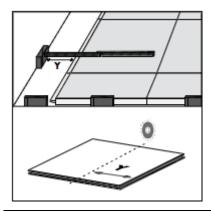
Для того чтобы завершить ряд, необходимо выпилить угловые плитки. Для нижнего угла вначале измерьте расстояние между расширительной распоркой и уложенным рядом.
