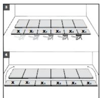
Исправьте мелкие погрешности с помощью бруска. Для этого поместите его на шов между двумя плитками и слегка обстучите молотком. Переместите получившийся ряд плиток поверх первого ряда.
