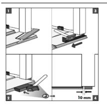
Распил панелей следует производить таким образом, чтобы после их укладки получить под дверью температурный шов шириной не менее 10 мм. Если вы не можете поднять панель, то сбейте ее с панелями, уже лежащими на полу, с помощью специального бруска для подбивки или молотка с монтажным ломиком.
