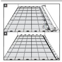
Исправьте мелкие погрешности с помощью бруска. Переместите ряд межу стеной и уложенным полом.
