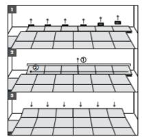
Теперь вернитесь к первому ряду. - Уберите расширительные распорки. Приподнимите ряд целиком и сдвиньте его таким образом, чтобы стыки плиток выровнялись с остальными рядами. Нажмите на плитки, для того чтобы ряды защелкнулись.
