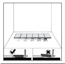
Завершите первый ряд, соединяя плитки под углом одну за одной. Постарайтесь уложить плитки таким образом, чтобы они образовывали одну линию. Мелкие погрешности можно исправить с помощью бруска. Для этого поместите его на шов между двумя плитками. Убедитесь, что брусок установлен, как показано на рисунке, и слегка обстучите молотком. Таким образом можно добиться идеально прямой линии плиток.
