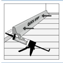
Установите плинтус поверх подложки/пленки, выходящей на стену из-под пола. Ни в коем случае не прикрепляйте плинтус к полу. Указанный способ позволяет напольному покрытию расширяться и сжиматься под плинтусом. В тех местах, где невозможно разместить профили или плинтусы, заполните температурные швы пластичным герметиком.
