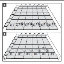
Теперь соберите ряд плиток X. Постарайтесь уложить плитки таким образом, чтобы они образовывали одну линию. Исправьте мелкие погрешности с помощью бруска. Переместите ряд X между стеной и уложенным полом.
