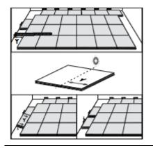
После укладки третьего ряда, отмерьте и отрежьте плитку размером Y между стеной и законченным рядом. Не забудьте вставить расширительную распорку. Вставьте плитку Y, сдвинув на 10 см относительно линии соединения 2-го и 3-го рядов.
